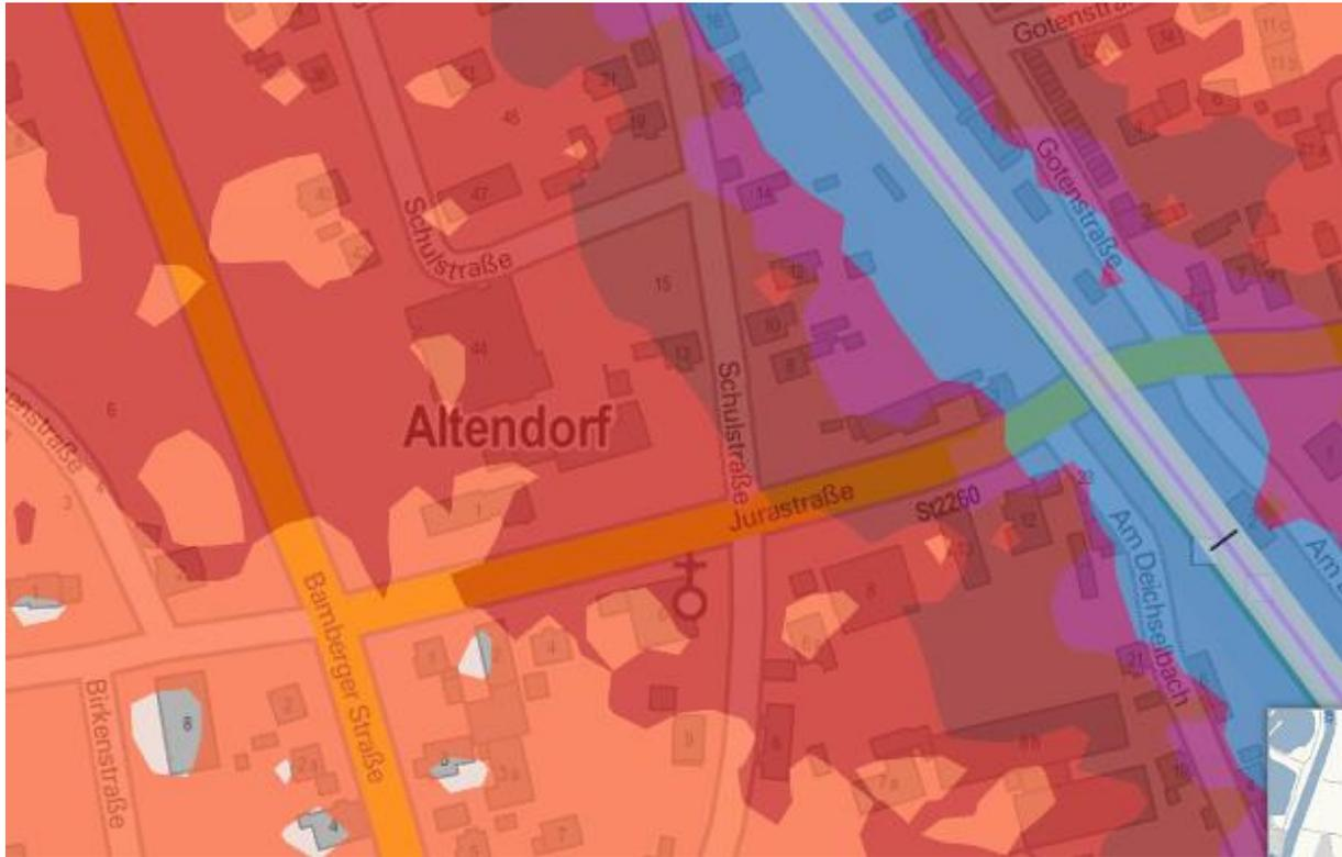
Abb.: Eisenbahn-Bundesamt, Isophonen der Fassadenpegel des Bahnbetriebs 2016 an Kita und Schule
